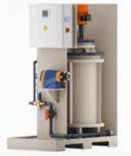
La station de préparation en ligne DULCODOS UL1a est dotée d'une chambre de mélange spéciale dans laquelle les polymères liquides sont dosés via des pompes péristaltiques ou doseuses. Le mélange optimal avec de l'eau permet d'obtenir une solution de polymère entièrement activée dans la chambre de maturation, avec un temps de maturation d'env. 15 min.
