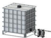
**Pompa installata al di sotto del fluido (sottobattente)**
