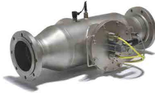
**Dulcodes A** è un impianto UV compatto. Le lampade a media pressione con resa ottimizzata garantiscono una disinfezione efficiente dell'acqua potabile e la decomposizione fotochimica degli agenti ossidanti o del cloro combinato.
