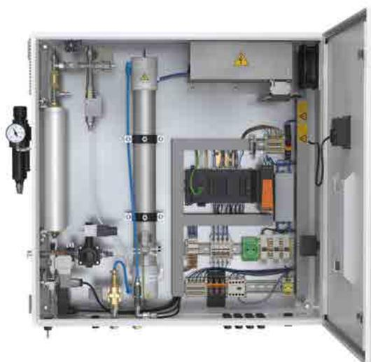
Gli impianti ozono della serie **OZONFILT OZVb** sono impianti a pressione nei quali il gas d'esercizio - aria od ossigeno viene immesso in pressione nel generatore di ozono.
