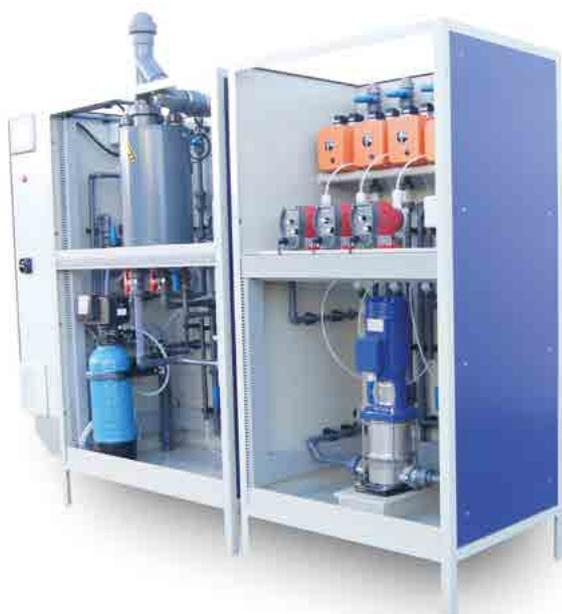
I sistemi per l'elettrolisi del tipo **CHLORINSITU V** producono gas di cloro di elevata purezza tramite un processo sotto vuoto controllato. L'impianto prepara una soluzione salina saturata che viene sottoposta ad elettrolisi all'interno di una cella con membrana di separazione.
