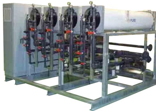
**L'elettrodeionizzazione** (o EDI) è un processo continuo che usa contemporaneamente resine a scambio ionico, membrane selettive e corrente elettrica per rimuovere bassi contenuti di sali dall'acqua di alimento, senza l'uso di prodotti chimici. Questo processo permette di erogare in continua acqua di elevata qualità (fino a **16 Megahoms**) se alimentato con acqua adeguatamente trattata.
