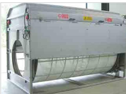
Filtro a tamburo rotante semisommerso al 60% per la rimozione dei solidi sospesi e per l'abbattimento di COD, BOD5 e fosforo legati ad essi. Adatto per la filtrazione dei reflui civili e industriali, acque per uso potabile, di processo e in allevamenti ittici.
