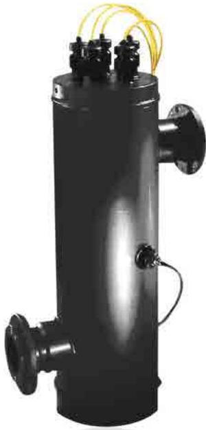
Per la disinfezione di **acque saline** (acque termali, acqua di mare) può essere utilizzata la serie **Dulcodes LP in PE-HD** con lampade a bassa pressione da 130 o 290 W alimentate e tenute in funzione in modo delicato da ballast elettronici.
