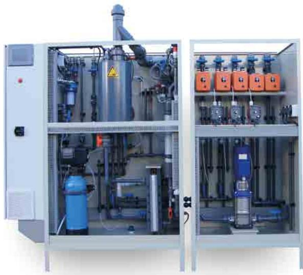
I sistemi ad elettrolisi **CHLORINSITU V** plus producono cloro gas di elevata purezza tramite un sicuro processo sotto vuoto. Il gas si dissolve immediatamente nell'acqua da trattare sotto forma di acido ipocloroso.
