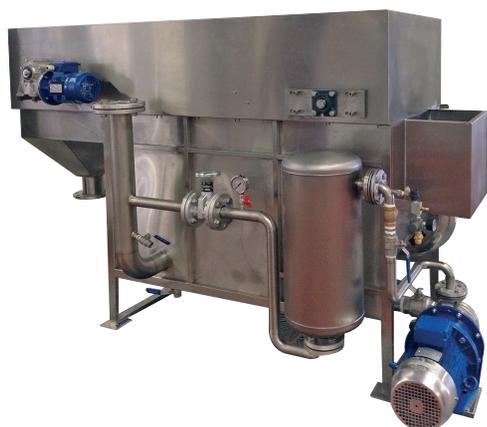
Il flottatore è un impianto per il trattamento chimico-fisico delle acque, esso utilizza aria disciolta per ottenere la separazione solido/liquido. L'introduzione dell'aria nell'acqua permette la creazione di bollicine d'aria che a contatto con le particelle sospese ne provocano la risalita in superficie modificando così la densità dei materiali.
