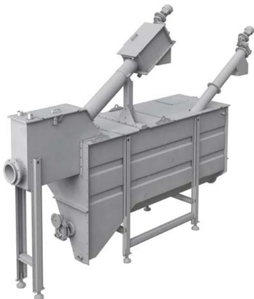
L'unità combinata modello SET 3 attua una prima grigliatura tramite una filtrococlea posta in testa alla macchina; le particelle di dimensioni superiori alla spaziatura del vaglio richiesta rimangono intrappolate. Grazie ad una serie di spazzole montate sulla coclea vengono rimossi e portati verso l'alto i solidi che vengono lavati e compattati prima di essere scaricati all'esterno. Grazie anche ad ugelli ad alta pressione il vaglio rimane costantemente pulito e privo di solidi.
