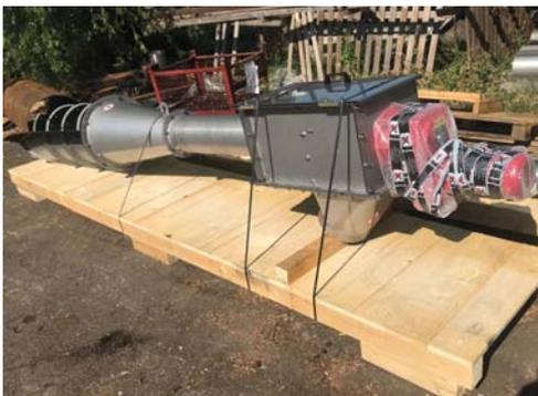
A seconda del tipo di applicazione, sono disponibili due versioni: la filtrococlea installata direttamente in canale oppure fornita completa di cassone, con flange di ingresso e uscita del liquido e, a richiesta, con griglia laterale di by-pass.
