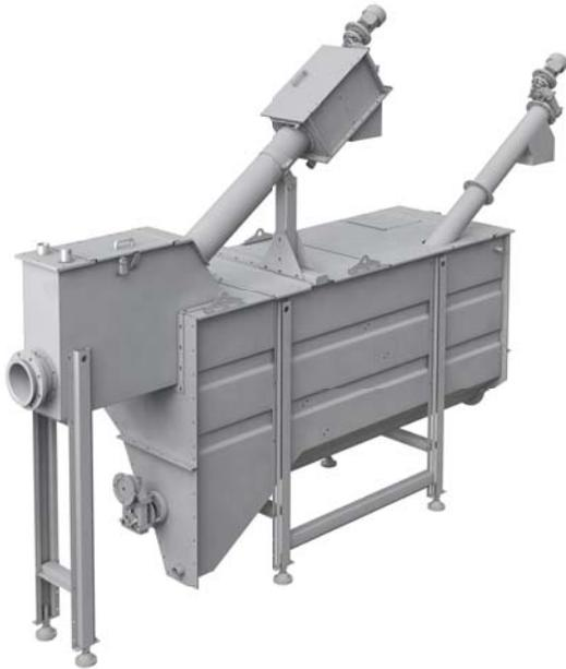
L'unità combinata modello SET 2. attua una prima grigliatura tramite una filtrococlea posta in testa alla macchina; le particelle di dimensioni superiori alla spaziatura del vaglio richiesti rimangono intrappolate. Grazie ad una serie di spazzole montate sulla coclea vengono rimossi e portati verso l'alto i solidi che vengono lavati e compattati prima di essere scaricati all'esterno. Grazie anche ad ugelli ad alta pressione il vaglio rimane costantemente pulito e privo di solidi.
